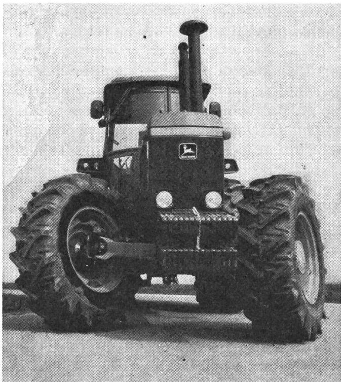
blocage automatique du différentiel avant, le freinage sur les 4 roues, les deux vérins de direction et la facilité d'enclencher le pont avant au moyen d'un simple commutateur à bascule.
