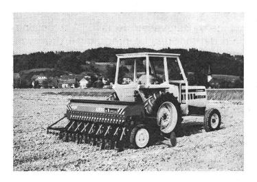
D'autre part, les semoirs de 2,5 à 3 m de large, de 15 à 21 socs peuvent être équipés d'un dispositif automatique pour traceurs. En montant une rangée double de dents flexibles devant les socs, le dernier passage avec la houe avant la semance n'est plus nécessaire, ou bien il est possible en fin d'été de semer directement après la récolte des cultures dérobées ou de l'engrais vert. Le contrôle du débit sans lever
