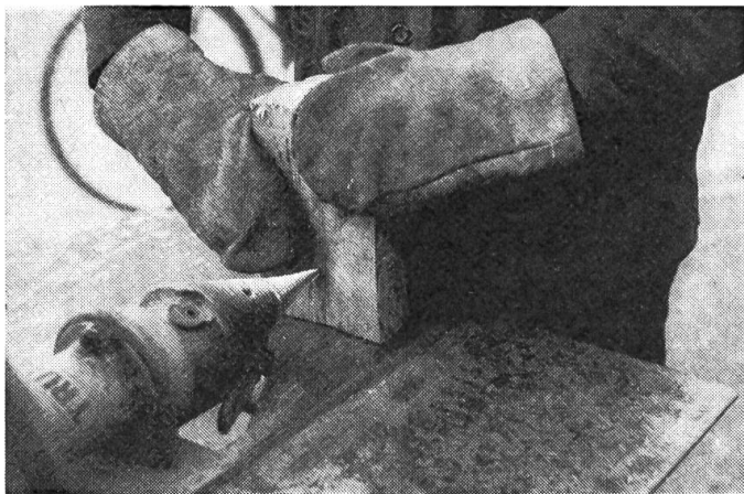
Fig. 6: Ne jamais mettre des gants ou des moufles pour manier une fendeuse en mouvement!
