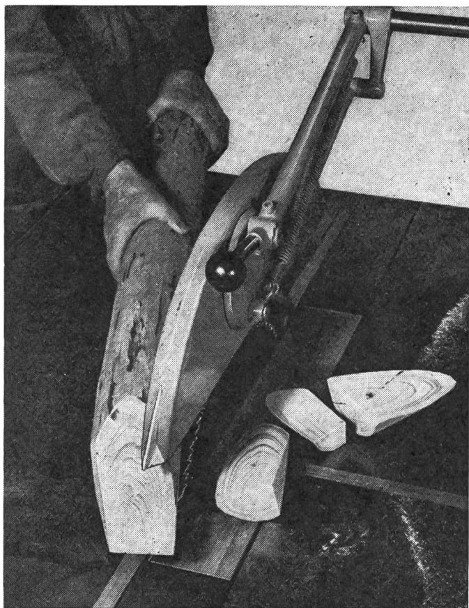
Fig. 3: Pointer un poteau en le tirant à soi et sans enlever le capot protecteur!
