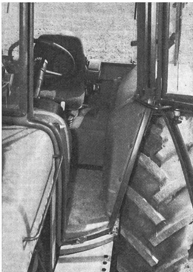
Fig. 1: Les constructeurs font tout leur possible pour assurer un aménagement optimal de la nouvelle cabine. Le niveau sonore enregistré dans la cabine est au-dessous de 80 dB(A).
