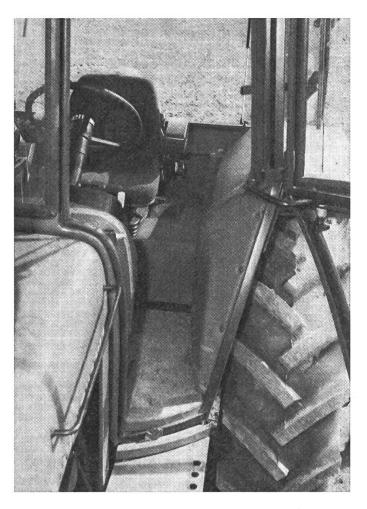
Fig. 1: Les constructeurs font tout leur possible pour assurer un aménagement optimal de la nouvelle cabine. Le niveau sonore enrégistré dans la cabine est au-dessous de 80 dB(A).
