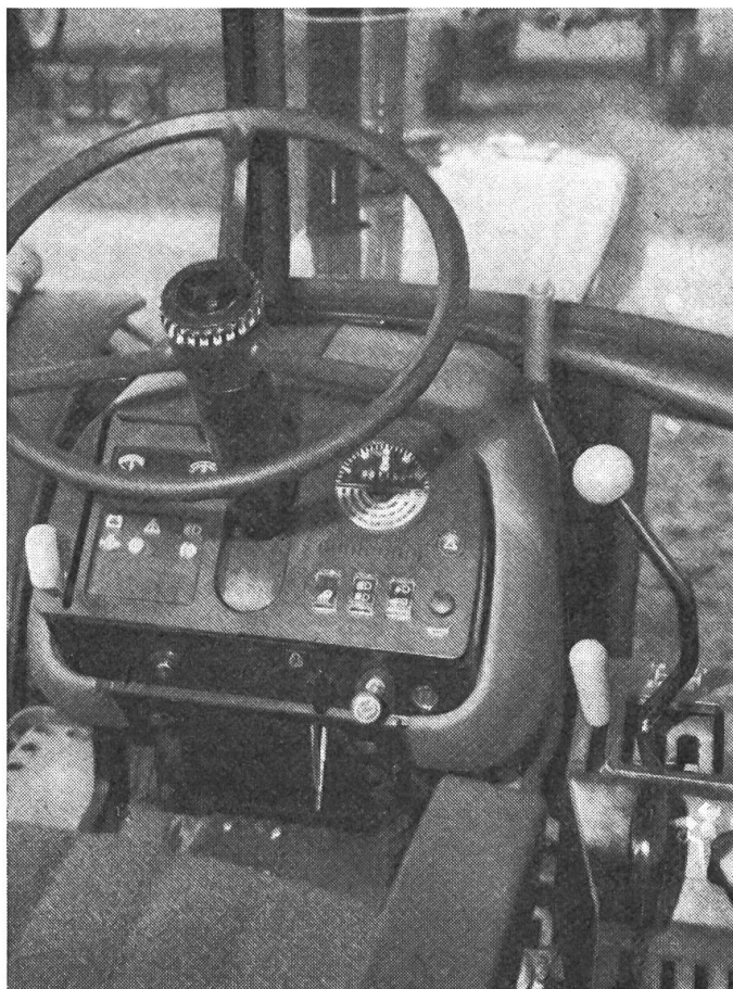
Fig. 2: Grâce à sa bombure spécialement étudiée, le pare-brise anti-reflets est exempt de propres vibrations et contribue à amoindrir le niveau de bruit. Tous les organes de commande sont à portée du conducteur.
