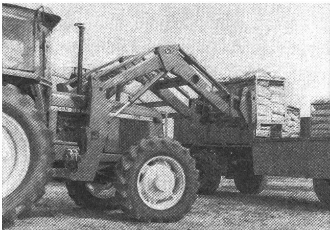
Fig. 4: Le chargeur frontal à mouvement parallèle automatique convient non seulement pour tous les travaux courants, mais aussi pour manœuvrer des palettes appropriées. Le conducteur peut l'atteler ou dételer sans aucune assistance en moins de cinq minutes.
