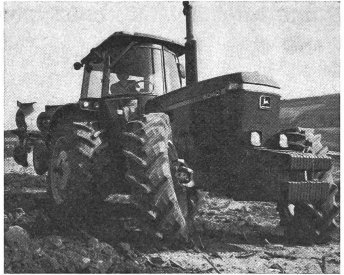
Fig. 3: Dans les virages, la roue avant intérieure s'incline en-dehors et s'écarte du châssis sous l'effet d'un angle de chasse particulièrement prononcé. Cela facilite les braquages serrés et rend possible une réduction exceptionnelle du cercle de direction.
