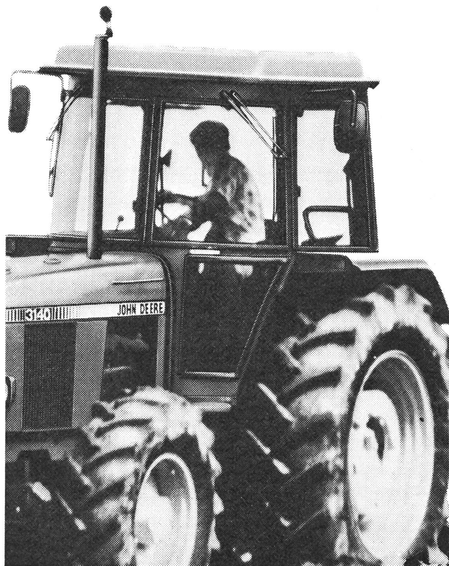
Le nouveau changement de vitesses à 2 leviers seulement sur console, offre 16 vitesses avant et 8 arrière. 8 vitesses peuvent être passées hydrauliquement sans débrayer.
