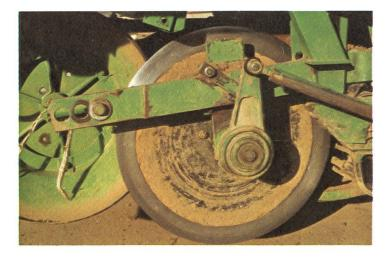
Fig. 3: Il s'agit également d'examiner tous les roulements quant à leur fonctionnement, leur mouvement et leurs défauts visibles. Des roulements douteux sont à échanger avec régularité si leur remplacement demande beaucoup de temps et de travail. Contrôler le fonctionnement des leviers articulés, des dispositifs de modification, des tendeurs. Les disques de séparation, les socs et rouleaux buttés seront examinés pour déceler d'éventuels dégâts.
