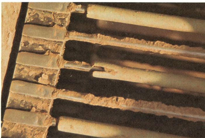
Fig. 7: Il faut également contrôler et, le cas échéant, remplacer les bandes nopées, les dispositifs de séparation et l'attelage de la roue élévatrice s'ils ont subi des dégâts ou montrent des signes d'usure. Gicler avec de la glycérine ou des produits spéciaux les parties en caoutchouc.
