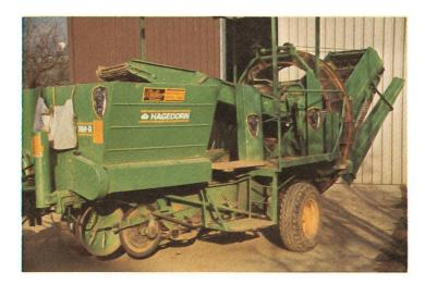
Fig. 1: Il s'agit d'effectuer le nettoyage de la machine par temps encore relativement doux, afin qu'elle sèche bien pour éviter des dégâts de corrosion. Des jets à haute pression et des produits de nettoyage chimiques facilitent beaucoup ce travail. Mais l'emploi de tels moyens requiert des connaissances spécialisées, car le but est d'empêcher des dommages sur l'environnement et les machines.
