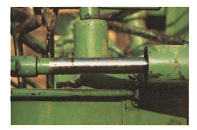
Fig. 5: Rentrer le piston à l'intérieur de son bras ou traiter la tige du piston avec un produit antirouille durable.
