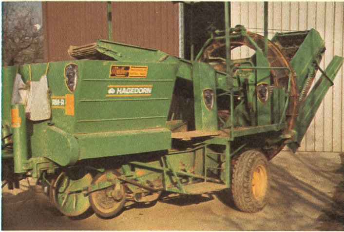
Fig. 2 : Il s'agit de tester les dispositifs de sécurité, les parties au service de l'homme et de la machine, quant à leur fonctionnement et de vérifier leurs valeurs de réglage (capots, protections métalliques et garnitures, accouplements de surcharge etc.).
