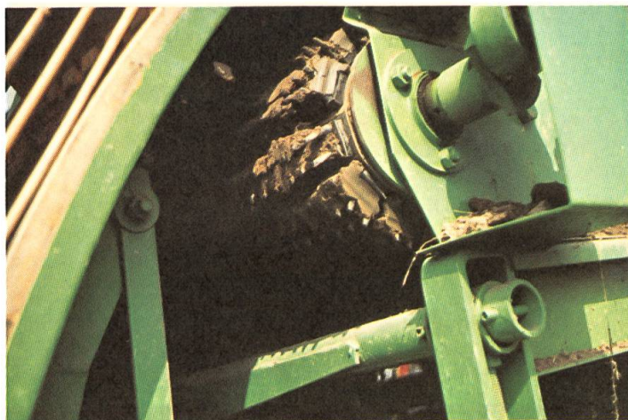
Fig. 7: Il faut également contrôler et, le cas échéant, remplacer les bandes nopées, les dispositifs de séparation et l'attelage de la roue élévatrice s'ils ont subi des dégâts ou montrent des signes d'usure. Gicler avec de la glycérine ou des produits spéciaux les parties en caoutchouc.
