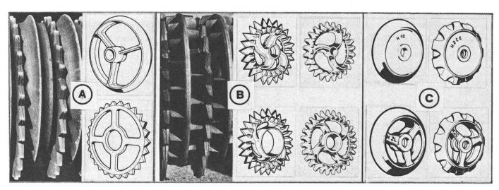
Fig. 9: Instruments d'intervention de rouleaux brise-mottes:
