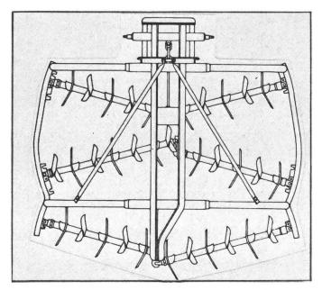
Fig. 6: Schéma d'une herse rotative à bêches avec six arbres porte-bêches, disposés sur trois rangs. L'angle de coupe des deux rangs d'arbre porte-bêches antérieurs est réglable en trois positions.
