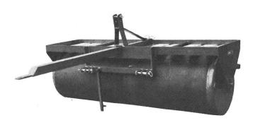
Fig. 13: Rouleau lisse avec cadre monté, en trois points, et timon. Le poids et l'efficacité de la machine peuvent être augmentés par remplissage d'eau des deux cylindres.
