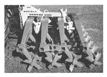
Fig. 7: Herse rotative a' bêches à quatre rangs en position de transport.
