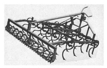
Fig. 2: Cultivateur fin à dents à ressort en S avec émotteur à un rang de barres dentées, dont les éléments rotatifs sont séparés par un palier médian. L'angle d'attaque des dents est réglable en continu au moyen d'une broche.
