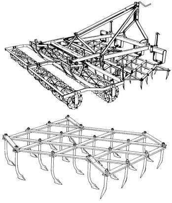
Fig. 1: Herse à dents à double champ, avec émotteur à deux rangs de barres dentées; en bas: herse à dents à patte d'oie.
