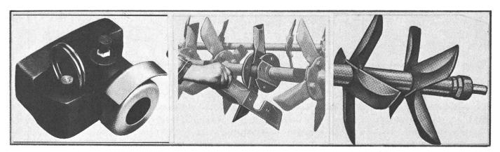
Fig. 8: A gauche: L'angle de coupe des arbres porte-bêches se modifie très vite par le moyen d'un maneton. Au centre: Les bêches sont fixées en croix sur une bride ou sur un arbre carré (à droite).
