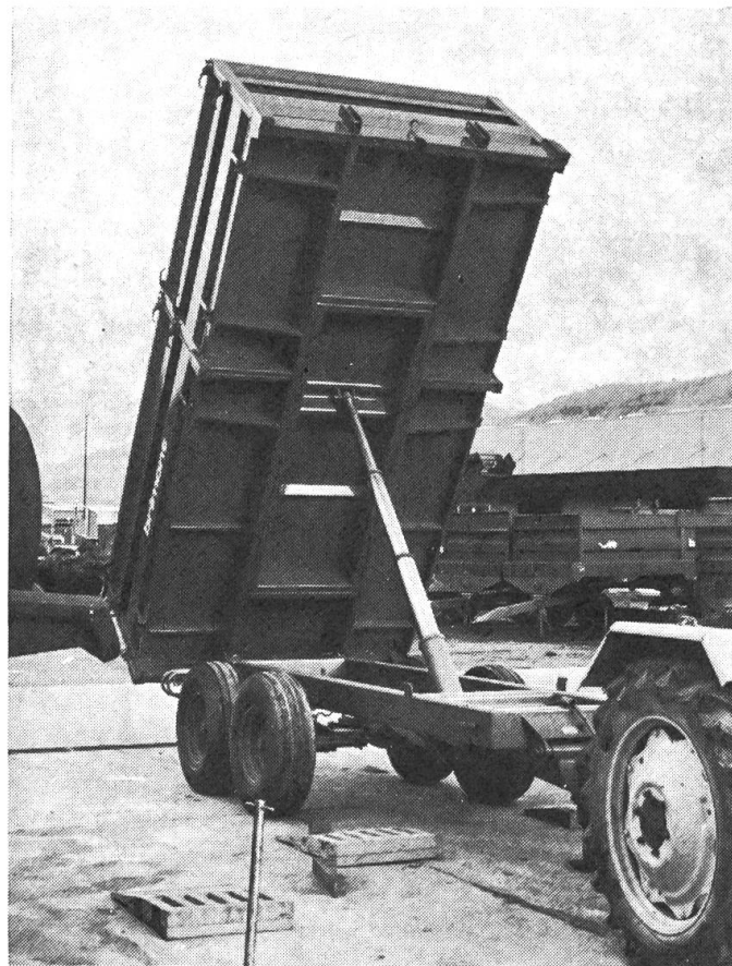
Fig. 8: Basculant: besoin en huile très élevé (17 l, par exemple). Tous les tracteurs n'autorisent pas un prélèvement de cette importance.
