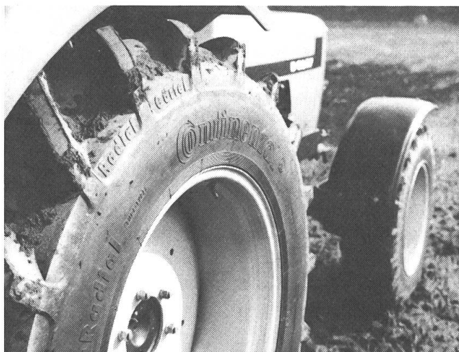
Fig. 1: Les pneus radiaux pour roues arrière des marques les plus connues ont fait l'objet d'essais comparatifs entrepris par l'Institut fédéral allemand de recherches agricoles de Völkensrode (RFA) et ont été effectués pour des sols, charges et taux de gonflage identiques.
