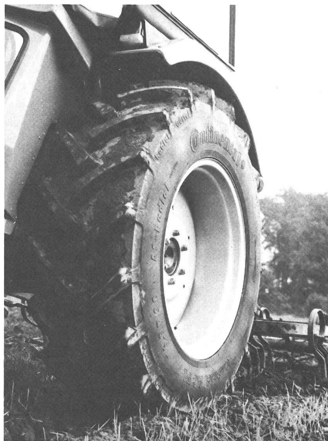
Fig. 2: La hauteur de profil, la conformation des barrettes ainsi que celle des gorges d'autonettoyage indispensables sur terrains humides et lourds du pneu radial Conti-Contract 51. Par contre, les épaulements ont subi certaines modifications, une arête profilée sur la bande de roulement contribue à une meilleure stabilité et résistance aux endommagements, et une nervure recouvrant le rebord de jante prévient toute pénétration de terre et d'autres corps étrangers entre la paroi du pneu et la jante.
