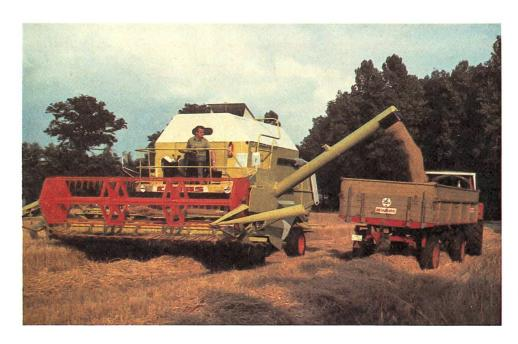
La possibilité de transporter le grain récolté doit correspondre à la puissance de la machine. Pour ne pas voir après la récolte un spectacle pareil, qui montre une perte excessive, . . .
