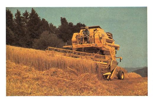
Les moissonneuses-batteuses spéciales pour terrains en pente peuvent travailler rapidement et sans perte même sur de fortes pentes.
