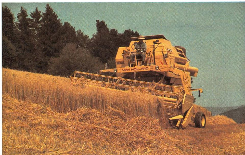
Les moissonneuses-batteuses spéciales pour terrains en pente peuvent travailler rapidement et sans perte même sur de fortes pentes.
