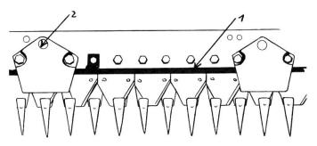
coupe. Grâce à cela, le bras oscillant ne produit pas de pressions diagonales sur la tête de couteau, qui est ainsi considérablement ménagée. La barre de coupe (fig. 2) résistante à l'usure, avec un nouveau guide-lame traversant (1) et des pince-lames (2) facilement réglables, assure une coupe
