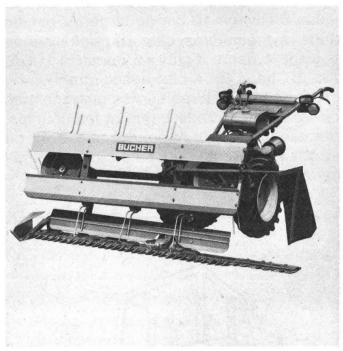
parfaite et constante du fourrage, un bon écoulement de l'herbe et un entretien minime. La nouvelle forme des dents et le nouveau guidage du *forme-andain* (fig. 3) à ruban permet de faucher très près d'obstacles, assure un bon dégagement de la barre de coupe et forme un andain compact dans tous les fourrages.
