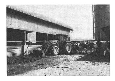
La productivité de ce couple tracteur/chargeur est particulièrement étonnante avec le système de mise à niveau automatique des modèles 245 et 260. Il suffit de remplir la benne, de la refermer (jusqu'à 40 degrés) et de lever les bras du chargeur. Le système de parallélogramme déformable maintient automatiquement l'angle de fermeture de la benne, empêchant ainsi tout débordement.
