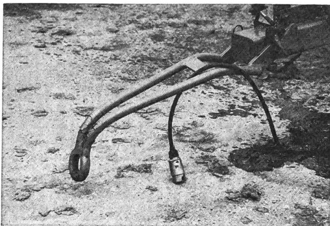
Anneau de couplage déformé par un accident. Sa réparation doit être confiée à un soudeur qualifié qui devrait tout d'abord déterminer la nature exacte des fissures et modifications structurales éventuelles de la zone de pliage.
