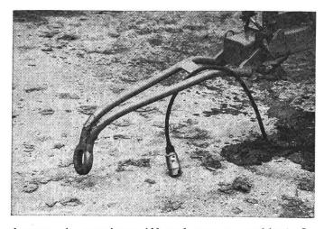
Anneau de couplage déformé par un accident. Sa réparation doit être confiée à un soudeur qualifié qui devrait tout d'abord déterminer la nature exacte des fissures et modifications structurales éventuelles de la zone de pliage.
