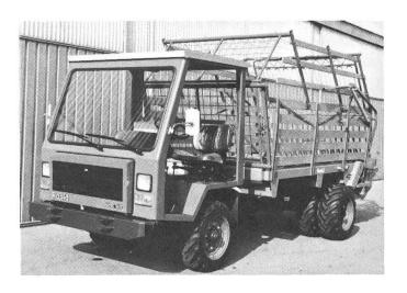
Grâce à un moteur Diesel à 3 cylindres de 34 ch qui a déjà fait ses preuves dans la fabrication des véhicules agricoles, le nouveau transporteur est en état de satisfaire aux prescriptions antibruit entrant en vigueur le 1er octobre 1982 pour les véhicules dont la vitesse est de 40 km/h.
