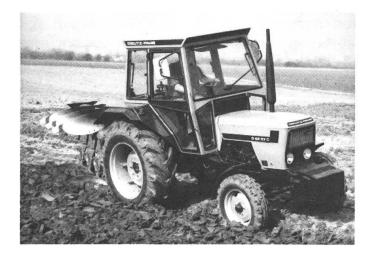
trois cylindres, très robuste et économique, tiré de la nouvelle série des 913. Les modèles D 6207 et D 6207 C sont remplacés par les D 6507 et D 6507 C (fig. 1) de 47 kW
