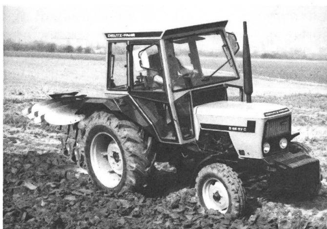
trois cylindres, très robuste et économique, tiré de la nouvelle série des 913. Les modèles D 6207 et D 6207 C sont remplacés par les D 6507 et D 6507 C (fig. 1) de 47 kW
