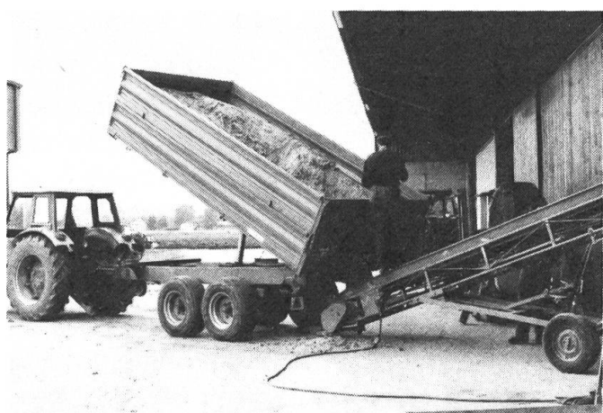
Fig. 9: Avec les moulins à céréales humides, le débit dépend fortement du dosage. En règle générale, le dosage à partir du véhicule de transport ne suffit pas. On obtient une alimentation régulière par un convoyeur à bande ou par un convoyeur à vis sans fin d'au moins 15 cm de diamètre.
