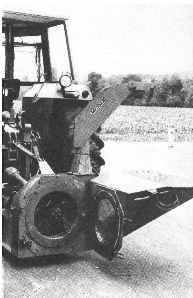
Fig. 10: Moulin à céréales humides. Selon la teneur en eau et la finesse de broyage désirée, le tamis circulaire est simplement et rapidement changé. En général, les trous ont 18 mm pour le CCM. Pour l'entraînement: au moins 80 kW par un débit de 12 t/h ou 50 kW à 9 t/h.
