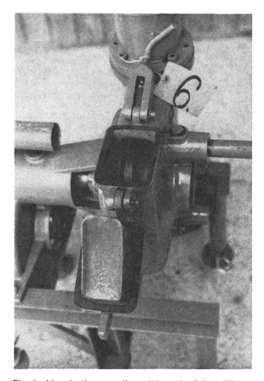
Fig. 4: L'aspiration ou l'expulsion du joint d'étanchéité sont évitées par une pose soignée et le collage de la pièce.
