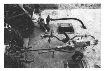
Fig. 1: Pompe à vis sans fin sur le banc d'essai. La pompe centrifuge visible à l'arrière-plan fournit la contre-pression souhaitée.
