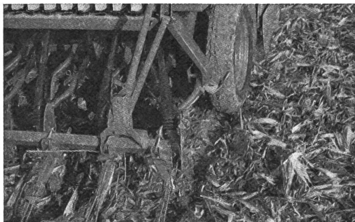
Fig. 5: L'emploi de socs à disque unique permet de réduire l'écartement des rangs à 12 cm sans causer des bourrages.
