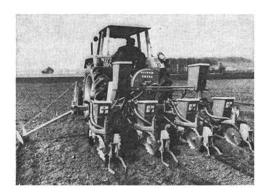
Les éléments prévus spécialement pour des semoirs à maïs tiennent compte des besoins spécifiques de la graine de cette plante sous le rapport de la préparation du lit de semences. Des éléments analogues à suspension à parallélogramme articulé assurent un enfouissement précis et régulier de monograines de betteraves. Tous ces organes sont facilement interchangeables et adaptables à l'une ou l'autre de ces cultures à l'aide de quelques pièces déta-
