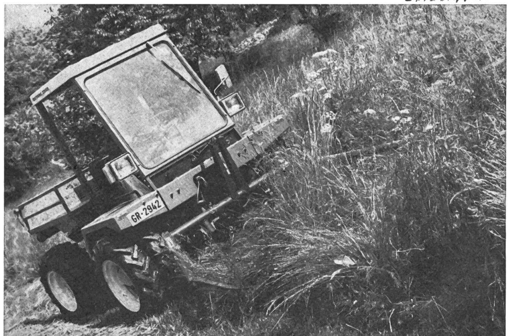
Fig. 4: Une direction arrière et des performances de fauchage très considérables caractérisent ce genre de machine.
