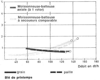
Fig. 2: Rapports entre le débit et les pertes de grains relatifs à de l'orge d'hiver et du blé de printemps (1). Dans le cas de moissonneuses-batteuses axiales, une augmentation de débit provoque une modification presque linéaire des pertes. Ce fait a été confirmé par des essais comparatifs anglais (2) et canadiens (3).
