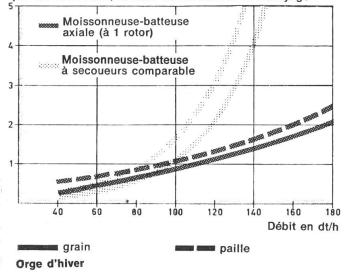
Pourcentage des pertes de grain causées respectivement par les secoueurs, le rotor ou les cribles de nettoyage
