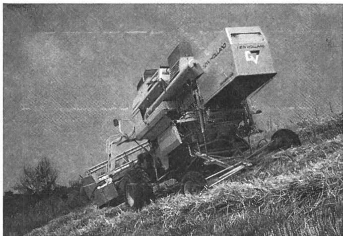
Fig. 5: Moissonneuse-batteuse autoniveleuse. Tant que la déclivité n'excède pas la fourchette de compensation, les conditions de travail sont pratiquement les mêmes qu'en plaine.
