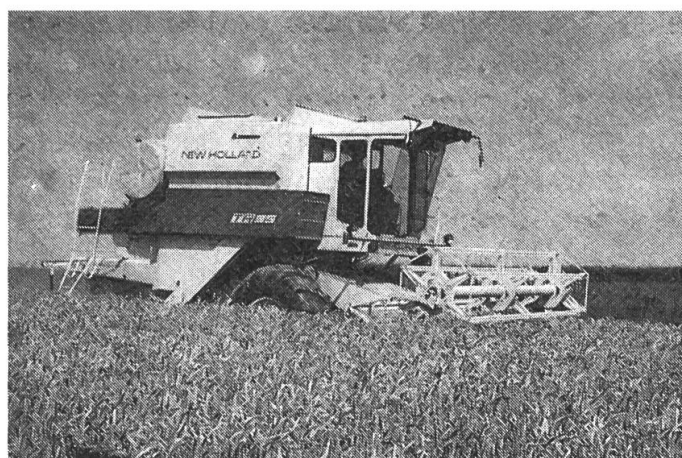
Fig. 4: En cas de travaux entrepris dans le sens de la ligne de la plus grande pente, les moissonneuses-batteuses axiales présentent certains avantages.
