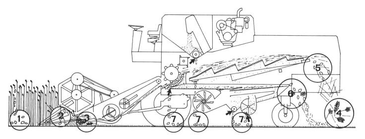
Fig. 6: Composition des pertes de grain occasionnées par les moissonneuses-batteuses.
