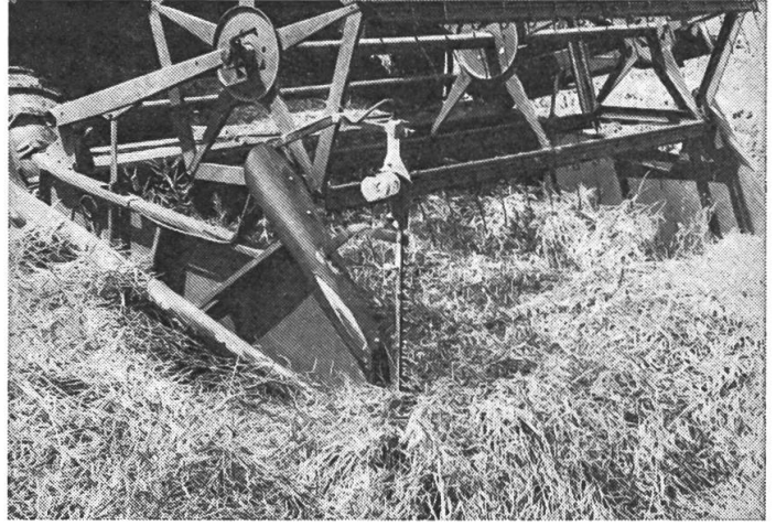
Fig. 7: Dans la règle, des barres de coupe latérales causent moins de pertes de grain que le déchirement des tiges de colza versé.
