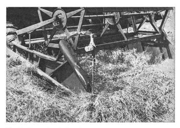
Fig. 7: Dans la règle, des barres de coupe latérales causent moins de pertes de grain que le déchirement des tiges de colza versé.
