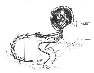
celle sous laquelle se trouvent les drains. On peut cependant aussi se passer d'un transrouleur en plaçant le cureur dans le prolongement d'un drain et en le reliant au dispositif propulseur/rétracteur à l'aide d'un tuyau en C.P.V.
