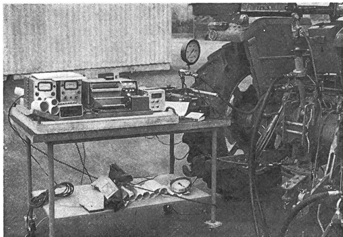
Fig. 4: Pour tester les soupapes de frein hydrauliques, le frein de remorque est reproduit par un simulateur. Force devant être exercée sur la pédale, pression de freinage, débit d'huile, temps de réponse et temps de constitution de pression sont relevés au moyen d'un enregistreur UV.
