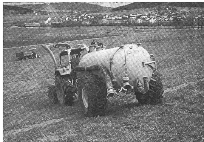
Fig. 10: Cuve à pression pourvue de pneumatiques de qualité optimale assurant un bon effet de freinage. Le profil des pneus AS est monté dans le sens contraire de la marche, de manière à obtenir un bon effet autonettoyant lors du freinage.
