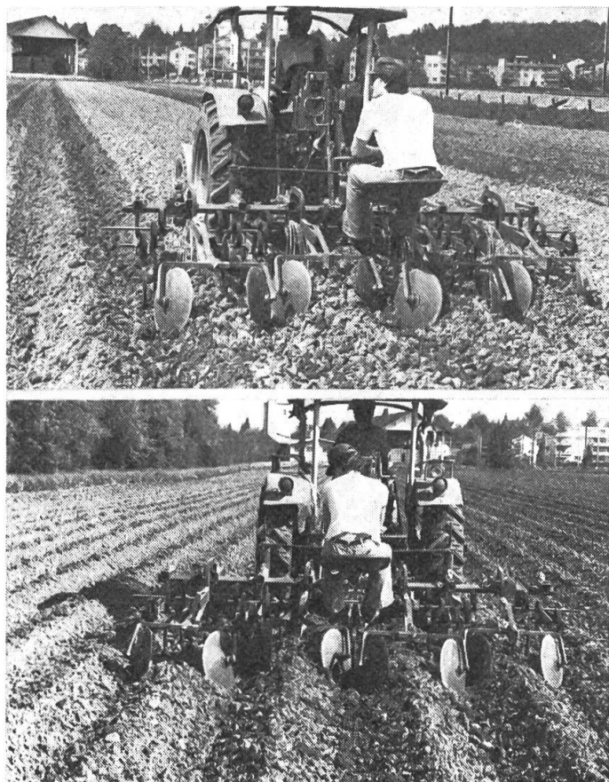
Fig. 4: En sol lourd et dur, le cultivateur polyvalent, en particulier dans les parcelles traitées au moyen du cultivateur à dents en S, a donné des billons moins hauts et contenant plus de mottes.
