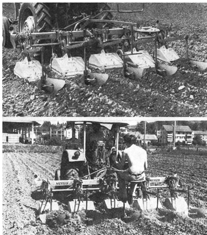
Fig.8: En sol lourd, les mottes se trouvant à 5 à 6 cm de profondeur sont émietées de manière clairement perceptible après le deuxième passage (en bas); les billons constitués sont larges et hauts.
