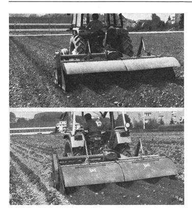
Fig. 6: Pour la préparation de billons plats lors du premier passage (en haut), les déflecteurs doivent être relevés. En position basse, ces derniers permettent de confectionner des billons relativement hauts.
