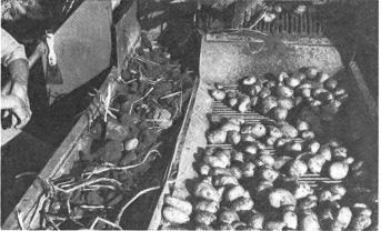
Fig. 13: En sol lourd, par suite de grandes quantités de mottes laissées par le cultivateur à dents en S (en haut), l'effet de séparation est demeuré faible; il a été par contre notablement meilleur après passage de la herse commandée par prise de force.
