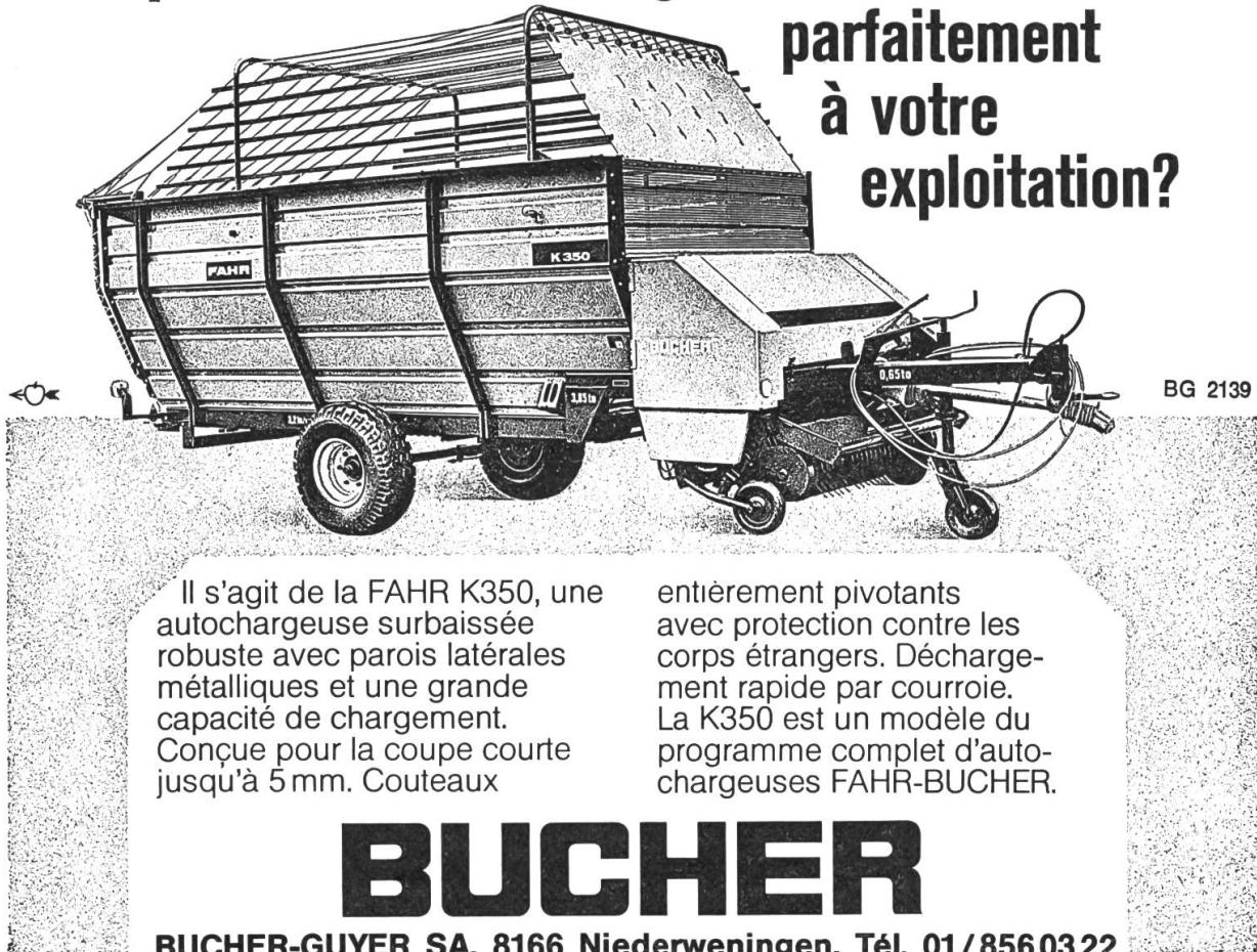
Il s'agit de la FAHR K350, une autochargeuse surbaissée robuste avec parois latérales métalliques et une grande capacité de chargement. Conçue pour la coupe courte jusqu'à 5 mm. Couteaux
