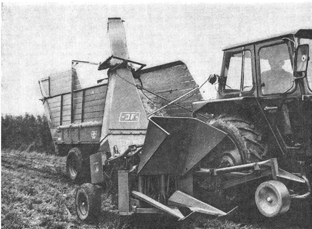
Le fourrage est coupé par le haut. La contre-lame est placée en haut et le fourrage récolté est directement dirigé vers la goulotte après le hachage.
