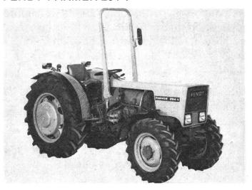
Il est muni d'un moteur 4 cylindres développant 65 DIN-PS (48 kW) et d'une boîte à vitesses avec 13 vitesses avant et 4 marches arrière, toutes synchronisées. La direction est hydrostatique.
