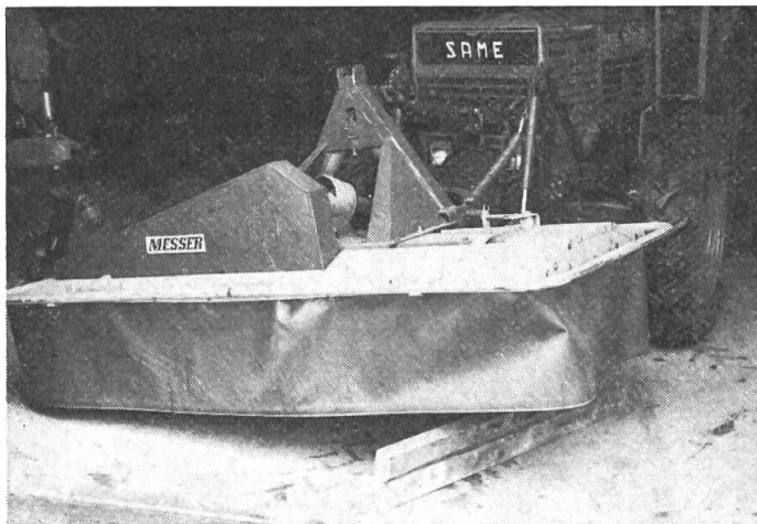
Fig. 4: Le sol agricole n'est jamais tout à fait plat; il faut donc pouvoir disposer d'une certaine torsion entre le tracteur et le dispositif de coupe.
