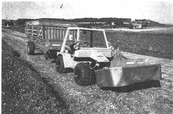
Fig. 2: Avec une faucheuse puissante, à deux essieux, on peut faucher et charger en une seule phase de travail, pour autant que l'on utilise une chargeuse légère.
