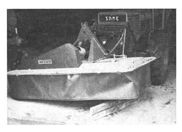
Fig. 4: Le sol agricole n'est jamais tout à fait plat; il faut donc pouvoir disposer d'une certaine torsion entre le tracteur et le dispositif de coupe.
