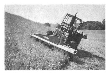
Fig. 3: On peut faire ce travail même sans la commande sur toutes les roues. Pour ce tracteur-ci, on a remplacé les roues avant assez étroites par des pneumatiques plus larges (13/75 — 16) comme pour les épandeuses de fumier et citernes à pression.
