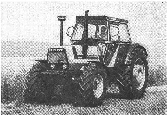
vitesses TW 91.10 entièrement synchronisée et à engrenage hélicoïdal particulièrement silencieux et peu sujet à l'usure. L'effet propulsif centralisé de son essieu moteur avant à train planétaire assure à la fois une garde au sol considérable, une transmission de puissance très sûre et un fort braquage. Ajoutons que l'arbre moteur avant est équipé d'un différentiel à verrouillage automatique Opitrac.
