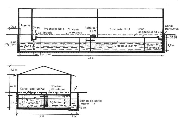
Fig. 2: Exemple d'un système à accumulation.
