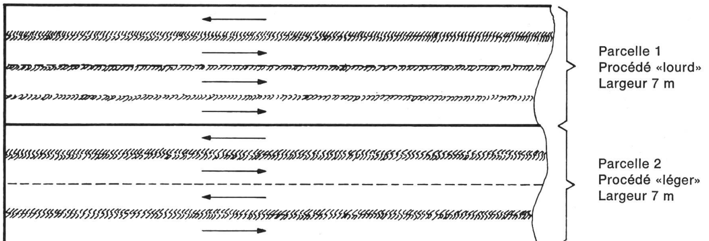
Fig. 1: Extrait d'une répétition (= deux parcelles). Les flèches marquent la direction de passage de la motofaucheuse. C'est ainsi qu'on obtient des andains doubles et simples.
