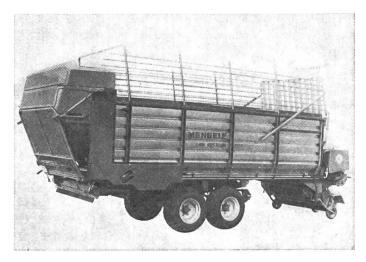
Fig. 2: Autochargeuse Mengele LW 310 Quadro (nouveauté DLG 1980) à convoyeur oscillant à grand travail.
