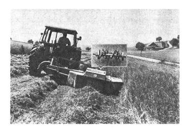
conditionneuses sont particulièrement en vogue en ce moment, car un conditionnement du fourrage fraîchement coupé a pour effet de raccourcir la période de fanage, de réduire les pertes d'effritement et d'économiser du courant lors du postséchage en grange. Pour le cas où la machine ne devrait servir qu'au fauchage, le dispositif conditionneur peut être enlevé moyennant quelques manipulations très simples.
