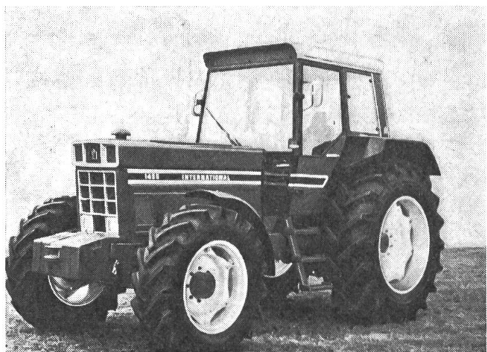
Fig. 1: Tracteur International à 4 roues motrices 1455 et moteur IH à 6 cylindres d'une puissance de 107 kW (145 ch). Boîte de vitesses graduées d'une façon optimale et entièrement synchronisées / essieux planétaires pour 4 roues motrices comportant des différentiels à verrouillage automatique IH / relevage hydraulique IH particulièrement puissant.
