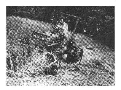
Un tracteur complet pour tous les usages en pente, hydraulique 3-points et prise de mouvement normale.
