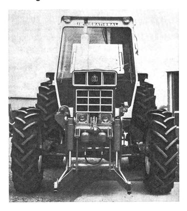
Le relevage frontal «BIS» permet d'économiser du temps, de la main-d'œuvre et du carburant. Il s'avère particulièrement utile lors des travaux de printemps, de l'évacuation des fanes de pommes de terre, de la fenaison et de la récolte des betteraves sucrières. Son attelage est extrêmement simple et facile, car les petites pièces prévue spécialement pour le montage s'adaptent parfaitement au tracteur. On les fixe au moyen de vis introduites dans des trous
