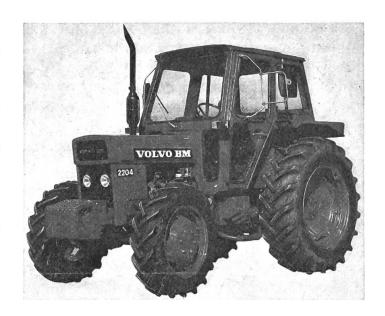
tits, mais non moins puissants, car ils sont équipés de moteurs Diesel de 56 ch (40,5 kW) à 4 cylindres et injection directe. La force motrice est transmise par une boîte de vitesses à 8 marches, livrable avec surmultiplication hydraulique également. Le numéro BM 2204 désigne la version à 4 roues motrices.
