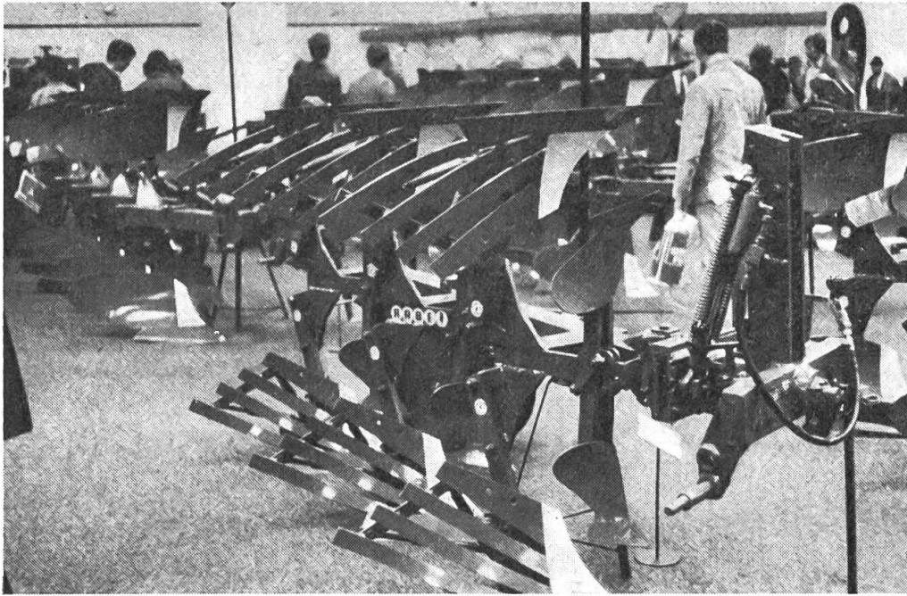
Fig. 2: Les versoirs à claire-voie facilitent le labourage de sols collants.
