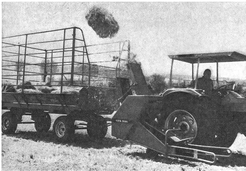
Fig. 6: La portée de ce lanceur de balles peut être modi- fiée au moyen d'un varia- teur du nombre de tours.
