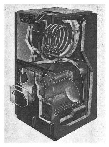
Fig. 1: Vue en coupe de la chaudière double Hoval-DuoLyt à mazout/gaz ou bois/charbon (sans inversion).
