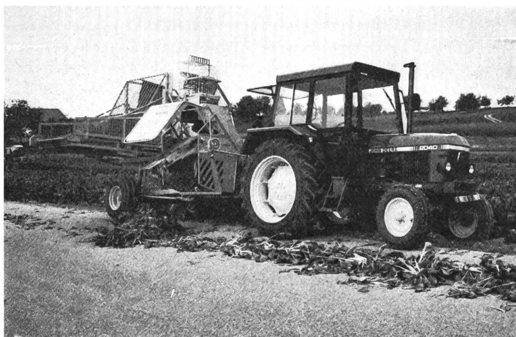
Fig. 2: Ce modèle à 1 rang permet de récolter simultanément les feuilles et les racines; les verts sont mis en andains et les betteraves s'accumulent dans une trémie d'où elles peuvent être transférées dans un véhicule stationnaire ou déchargées sur un tas en bord de champ.
