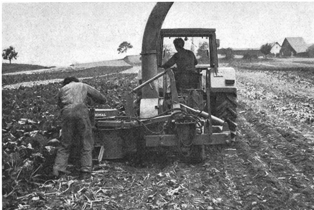
Fig. 3: La récolte biphasee consiste à couper tout d'abord les feuilles sans entamer la plupart des collets.
