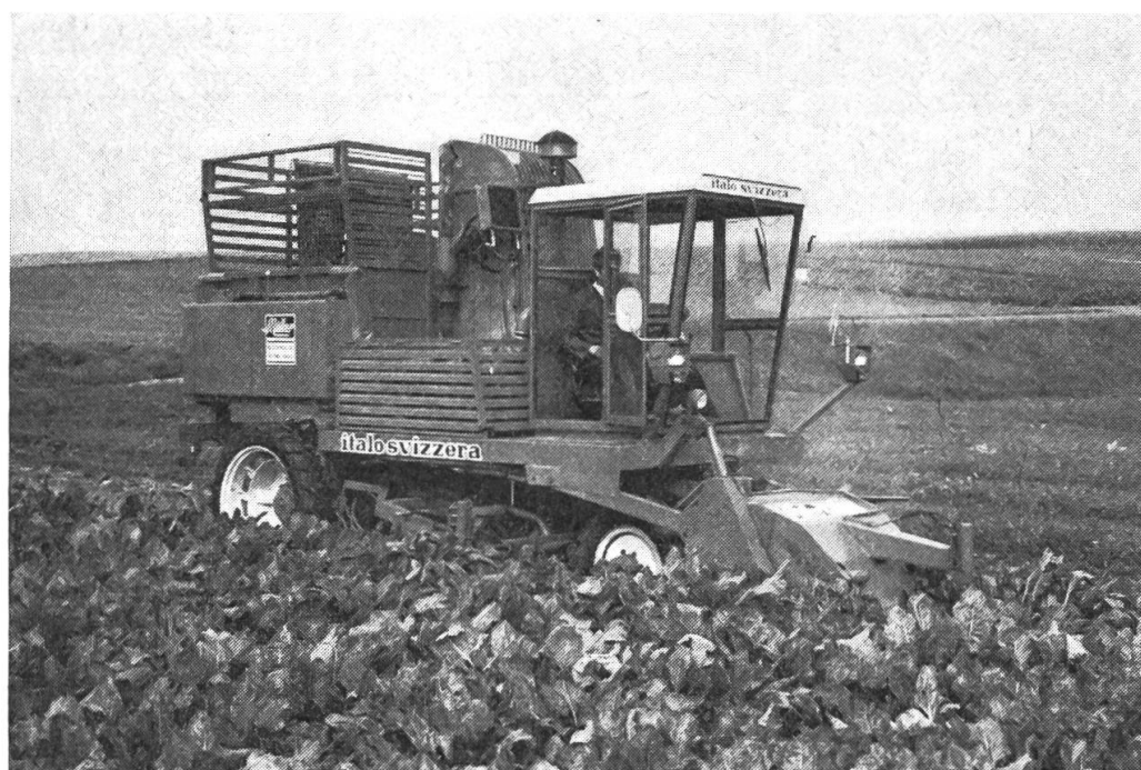
Fig. 7: Ainsi que tous les autres matériels automoteurs, une arracheuse totale comporte des organes de locomotion (moteur, boîte de vitesses, mécanisme de roulement) analogues à ceux d'un puissant tracteur qui ne peuvent être utilisés que pendant une période annuelle relativement courte.
