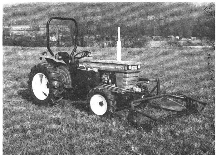
Busatis d'une largeur de jusqu'à 2,3 m ainsi que de pneus jumelés qui rendent ce porte-outils versatile particulièrement apte au travail sur pente.
