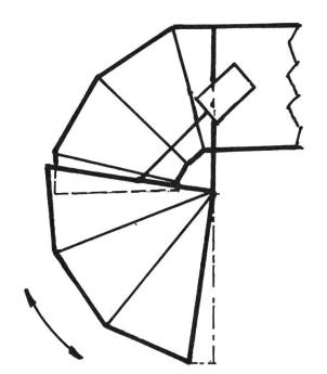
Fig. 3: Répartiteur complémentaire vers l'arrière à papillon ou volet en une pièce.
