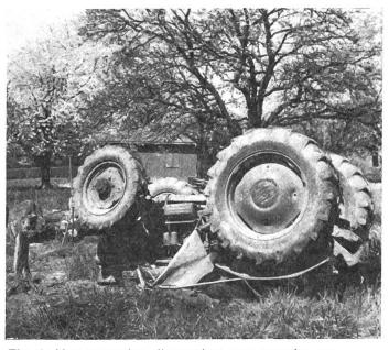
Fig. 1: Une tentative d'arracher une souche au moyen d'une chaîne de traction fixée trop haut eut pour résultat de faire capoter le tracteur en arrière et d'écraser le conducteur.
