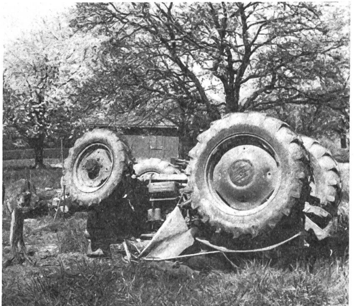
Fig. 1: Une tentative d'arracher une souche au moyen d'une chaîne de traction fixée trop haut eut pour résultat de faire capoter le tracteur en arrière et d'écraser le conducteur.
