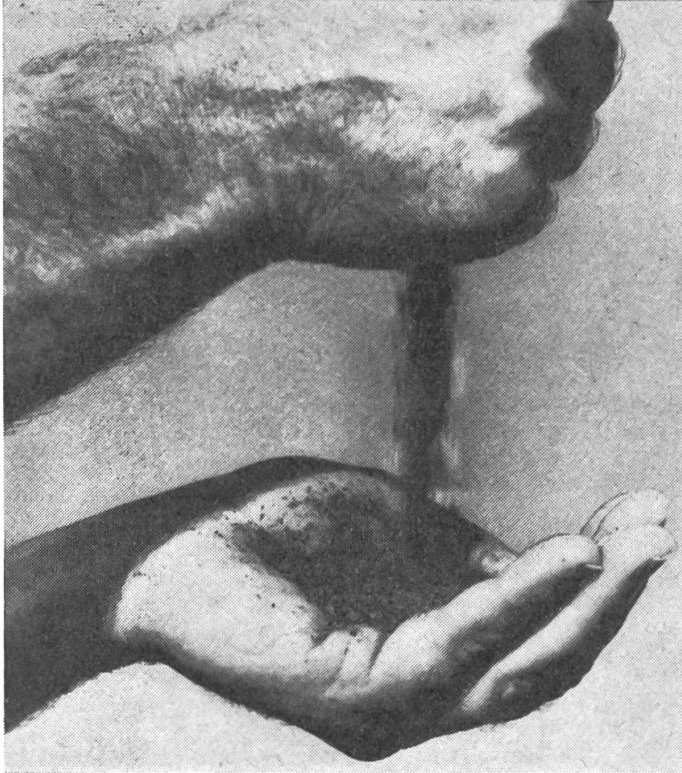
Fig. 2: Produit fini typique du Digesteur «Brill»: un engrais 2-2-2 sec, meuble et inodore ou un aliment concentré riche en protéine. L'échantillon présenté ici consiste en un mélange de fientes de poules et de sciure.
