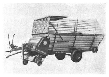
Fig. 2: Autochargeuse MENGELE surbaissée à convoyeur à griffe modèle LW 320 Super.
