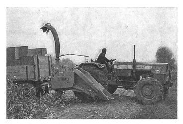
Fig. 6: Cueilleur-broyeur monté, à 1 rangée.
