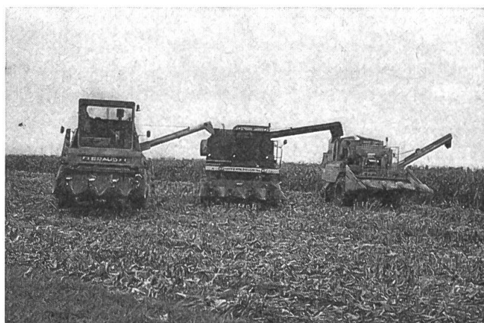
Fig. 3: Batteuse à maïs spéciale, moissonneuse-batteuse axiale, moissonneuse-batteuse conventionnelle (toutes les machines sont à 4 rangées avec cueilleur), photographiées au moment des essais comparatifs.
