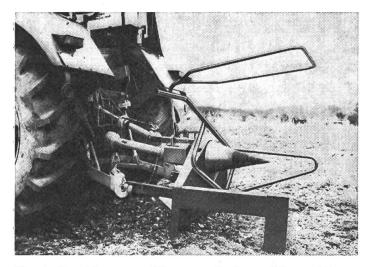
Fig. 1: Machine complète avec limiteur débrayable et arceau de sécurité.
