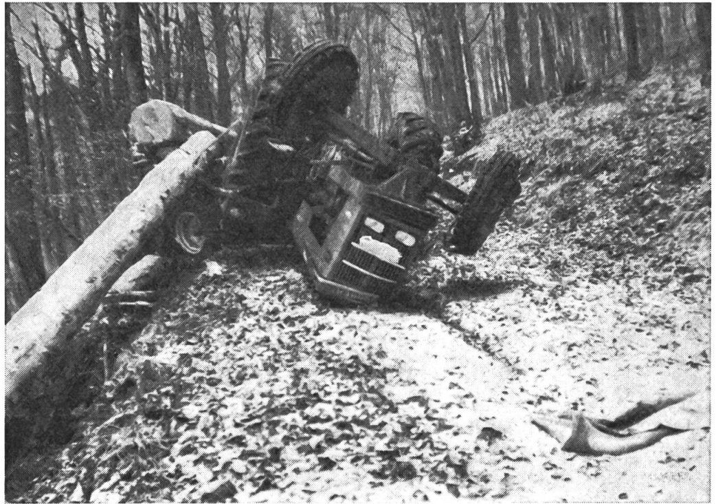
Fig. 4: L'allure d'une remorque à freins à inertie chargée de billons ne put plus être ralentie sur une route mouillée, couverte de feuilles mortes et saupoudrée de neige.
