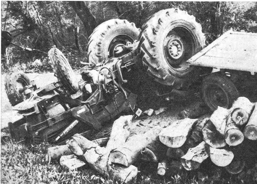
Fig. 3: Des freins inefficaces (freins à vis) ont causé lors d'un transport de bois de feu un grave accident. Bilan: un mort et trois grands blessés.
