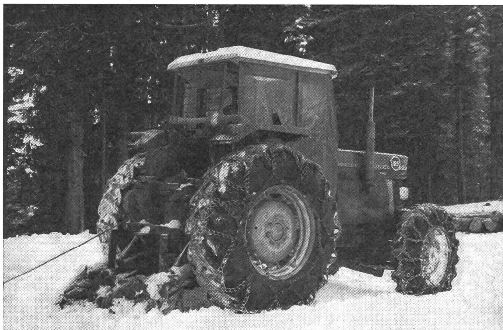
Fig. 1: En vue de protéger le machiniste et ses aides contre des accidents, le tracteur affecté au débardage doit être équipé d'une cabine ou d'un cadre ou arceau de sécurité, d'un siège dit orthopédique, d'une grille de protection arrière, d'un tire-câble et d'un bouclier de débardage.
