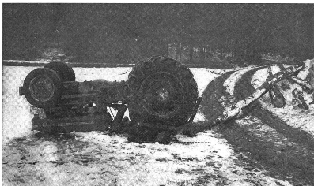
Fig. 2: Renversement de tracteur fatal dû à un point d'attelage trop haut (poussée du tronc remorqué).
