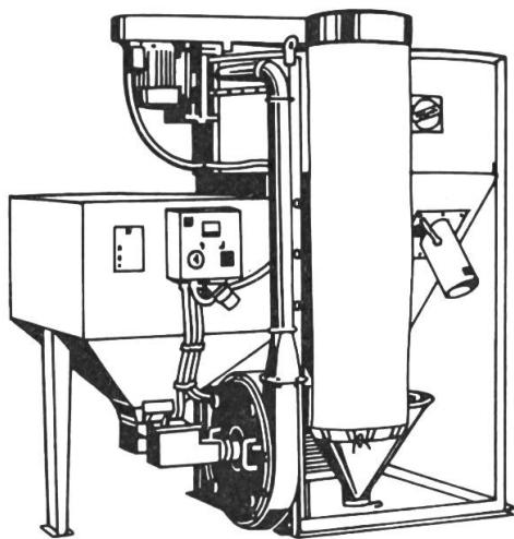
Seule installation compacte avec alimentation par auto-vibrateur selon ampérage du moteur.
