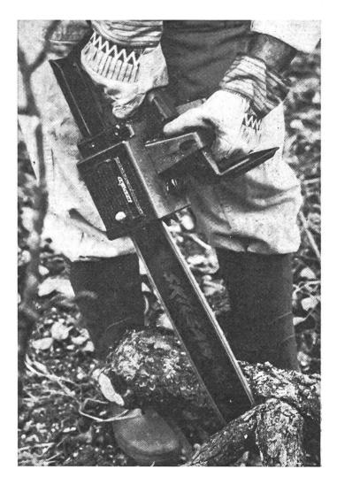
blement le bruit du moteur. Il possède en plus un pare-étincelles qui représente une grande protection contre les dangers d'incendie en forêts, dans les endroits très secs. Pour leur permettre un maniement aisé, les poignées ont un dessin ergonomique et ont été assemblées avec un système d'amortisseur de vibrations très effectif dans les poignées arrière. Les nouvelles
