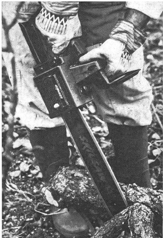
blement le bruit du moteur. Il possède en plus un pare-étincelles qui représente une grande protection contre les dangers d'incendie en forêts, dans les endroits très secs. Pour leur permettre un maniement aisés, les poignées ont un dessin ergonomique et ont été assemblées avec un système d'amortisseur de vibrations très effectif dans les poignées arrière. Les nouvelles
