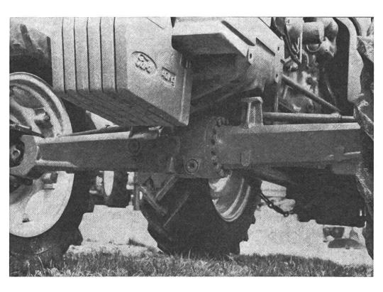
Fig. 4: L'essieu avant de la propulsion centrale atteint un braquage de 52º. Un jeu pendulaire considérable ainsi qu'une garde au sol très haute favorisent un emploi universel en forêt.
