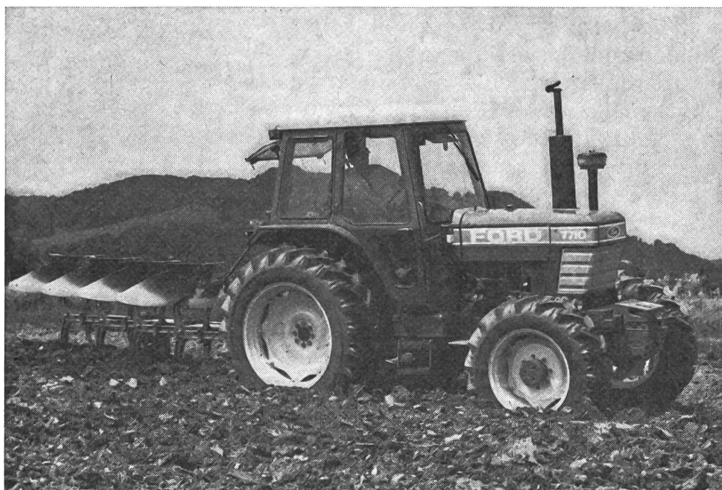
Fig. 1: Modèle 7710 à 4 cylindres, turbomoteur Diesel, 4303 cm 3 , essieu de direction avec verrouillage de différentiel, entraînement central avec braquage de 52°. 16 marches avant et 8 marches arrière, cabine originale Ford (82dBA).
