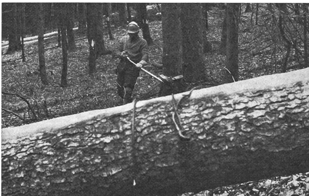
Fig. 5: On ne saurait plus se passer de ce tire-câble pour des raisons relevant de la sécurité et de l'allégement du travail. Office pour la sécurité du travail dans l'économie forestière (OSTEF).
