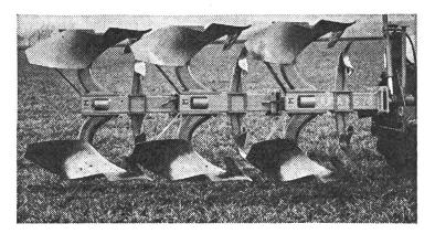
Système de sécurité hydraulique fonctionnant horizontalement et verticalement; il supprime arrêts et manoeuvres de recul.
