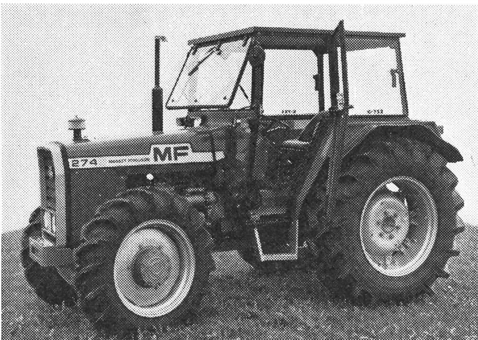
**estez l'entrée en cabine — et comparez-la avec d'autres marques.** L'entrée est extraordinairement aisée. La plate-forme moderne met le conducteur à l'abri des bruits et des vibrations. Montée sur silentblocs. Avec revêtement d'insonorisaton en-dessous de 90 phon.
