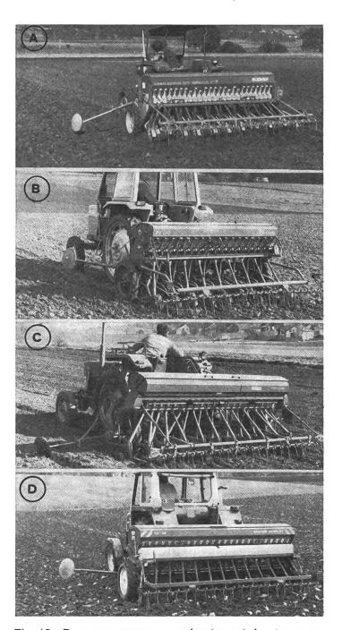
Fig. 10: Des socs-semeurs robustes et hauts, avec des étrilleuses à deux rangs et en deux parties assurent une bonne qualité de travail également dans les sols lourds.
