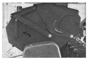
Fig. 4: Un indicateur pendulaire (flèche) facilite le maintien de la machine en position verticale, laquelle est importante aussi pour la position des socs-semeurs (dispositif présent seulement chez Nodet).
