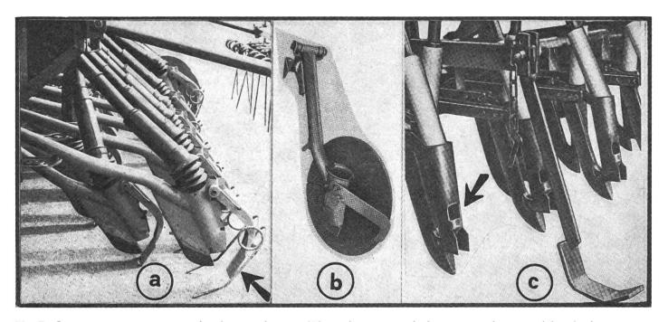
Fig. 7: Socs-semeurs avec entrée des goulottes téléscopiques protégée et appuie-socs (a), ainsi que socs monodisque (b), travaillent pratiquement sans jamais subir de bourrage (Amazone). Les deux appuis pivotants (c) n'empêchent le bourrage des socs que partiellement. Il arrive que des semences heurtent violemment les bords de l'ouverture des socs (flèche), s'échappent ainsi et n'atteignent plus la profondeur nécessaire (Fiona, Nordsten).
