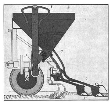
Fig. 2: Schéma du semoir pneumatique Accord. 1 = roue d'entraînement; 2 = trémie à semences; 3 = roue cannelée centrale; 4 = canal du diffuseur; 5 = soufflante; 6 = tube ondulé; 7 = distributeur; 8 = flexible à semences; 9 = socs-semeurs avec appuis pendulaires; 10 = recouvreur.
