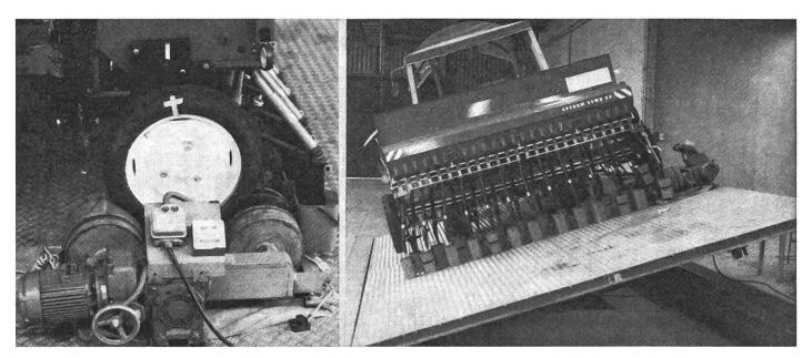
Fig. 5 Examen de l'exactitude des semis des différents semoirs, ainsi que de l'influence exercée sur la quantité de semences par la vitesse de marche et l'inclinaison. A gauche: la roue de commande de la machine est entraînée par un moteur électrique.
