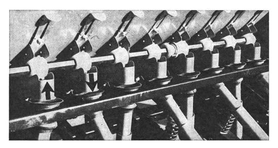
Fig. 6: Lorsque les parois des boîtiers sont basses et les entonnoirs des goulottes téléscopiques en caoutchouc, une partie des semences — en terrain déclive en particulier — tombent à côté et n'atteignent pas la profondeur utile (Roger).
